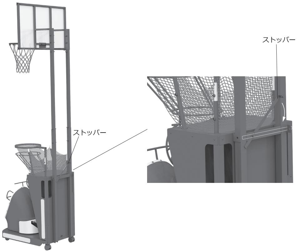
8 スッパーの両端をノブボルトで締め付けてください。
