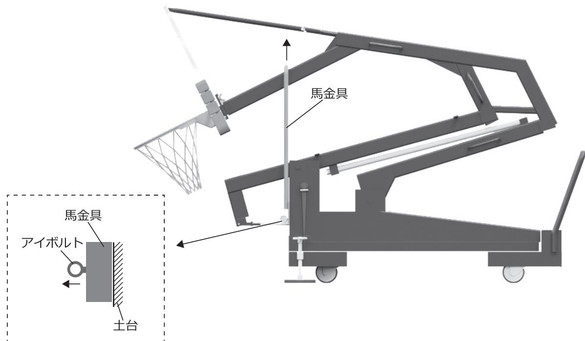
10 すじかい部の固定ピンと、すじかい金具の矢印を合わせて、ピンを抜いてください。抜いたピンは、一時置き穴に差し込んでください。
